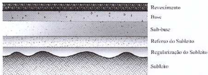
Figura 7.1 - Camadas de um pavimento flexível.
